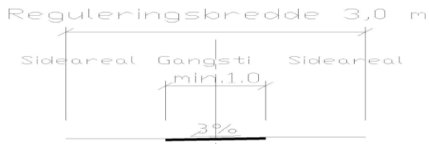
figur: normalprofil fra veinormen - gangsti som stikkvei
